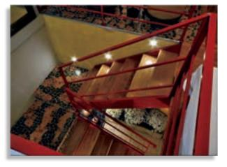
Na foto maior, trilhos eletrificados com projetores para PAR 20 de 50W/30° e 3000K, destacam o painel ilustrativo do bar, enquanto fitas de LED de 10W/m a 2700K, realçam o forro de madeira. Na foto menor, balizadores com LED de 1W a 2700K, iluminam a escada que liga o piso inferior ao térreo.
