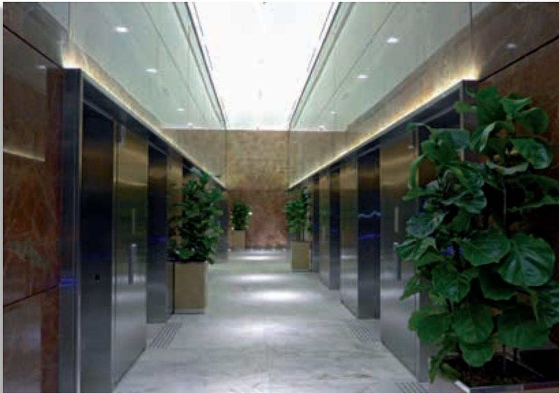
Fitas de LED de 15W/m a 3000K, acima das portas dos elevadores, jogam luz para o forro de gesso. Enquanto embutidos no teto, equipados com vapor metálico de 35W a 3000K, iluminam o corredor.
