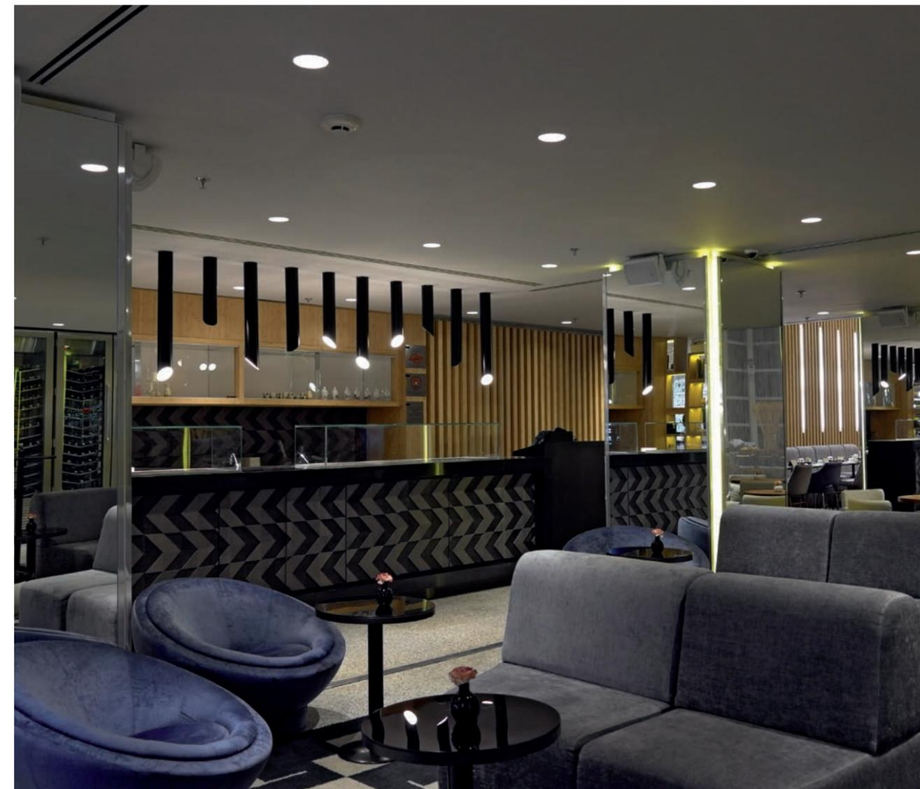
Para destaque do lavabo, foram instaladas no vidro, acima de cada uma das cubas, luminárias circulares com fitas de LED de 8W/m a 3000K e fechamento em acrílico. Todas as colunas do lobby, lounge e restaurante são espelhadas em suas quatro faces. Em cada um dos vertes das colunas foram aplicadas fitas LED de 5W/m a 2700K e fechamento em acrílico para destaque destes elementos.
