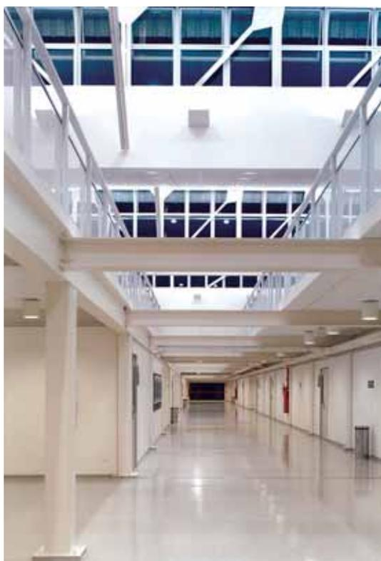
Sobre os grandes rasgos na laje, que resultaram num pé-direito duplo para o térreo, a iluminação direta embutida no forro com luminárias assimétricas e a iluminação indireta dos *sheds* evitaram ofuscamento.
