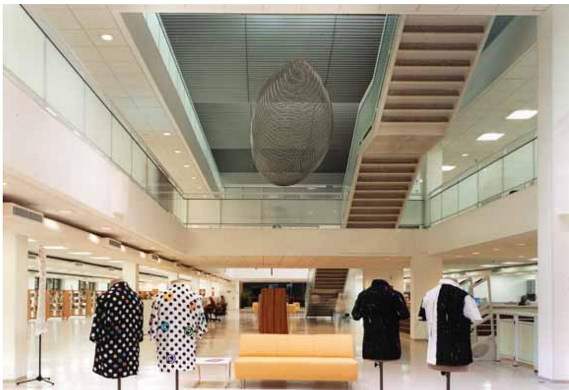
Os sistemas de iluminação difusa dos pavimentos, aliados à iluminação direta nas passarelas e à iluminação indireta do forro curvo do edifício são responsáveis pela iluminação do átrio.
