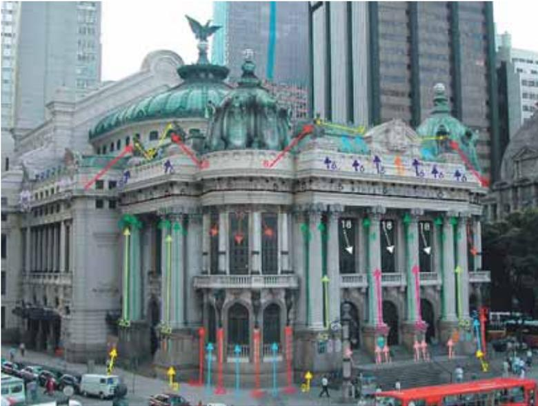
Figura 2: Aparelhos embutidos, com fecho muito fechado, iluminam as partes baixas das rotundas...
