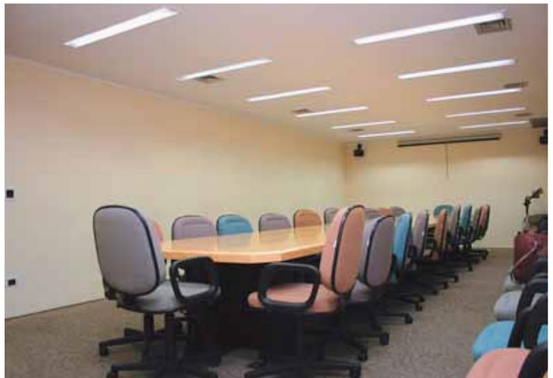
foco luminoso nas células parabólicas baseia-se na forma das paredes inclinadas. Elas atuam como pequenos refletores e dirigem a luz até a área de trabalho – zona de 0 a 45°. A ausência de luz sobre os 45° elimina a fonte de brilho e reflexo direto no plano de trabalho. O conforto visual é de 90% para todas as células (ver fig. 1).
