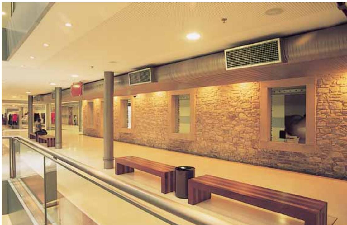
O nível de iluminação das circulações foi calculado para 250 lux de iluminância média, obtida através de luminárias embutidas para lâmpadas fluorescentes compactas de 32W e temperatura de cor de 3000K.
