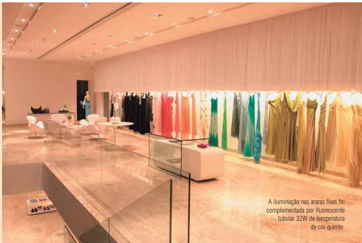
A iluminação nas araras fixas foi complementada por fluorescente tubular 32W de temperatura de cor quente.
