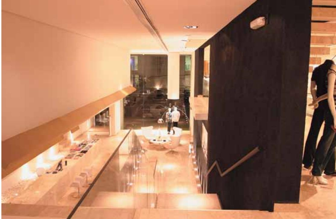
embutidos de piso para lâmpadas halógenas refletoras, munidos com grelha antiofuscamento, que estão interligadas a um sistema de automação. Este sistema, permanentemente acionado, cria diversas ambiências para o mesmo espaço. A imponência deste espaço é realçada por um grande rebatedor de gesso por sobre o balcão de recepção. Microembutidos para halógenas dicróicas de 35W e foco bastante concentrado instalados no rebatedor proporcionam uma iluminação precisa para o balcão de recepção.
