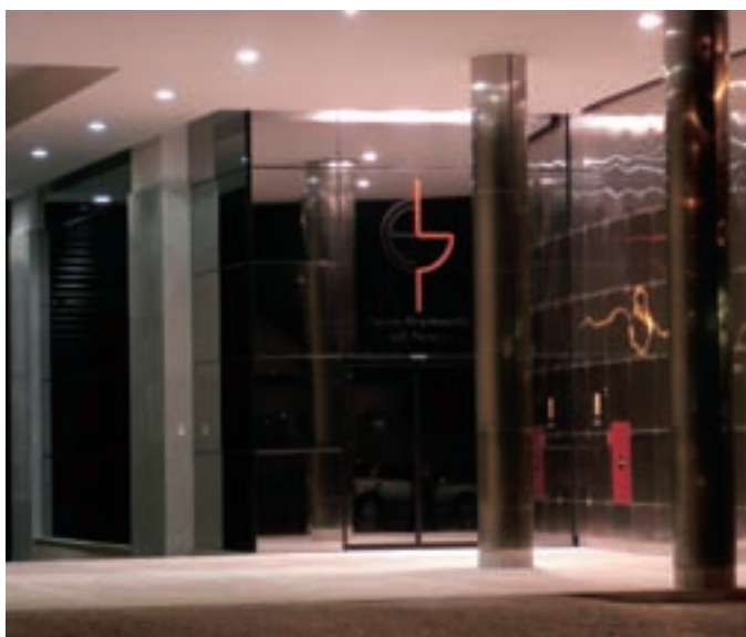
Área externa do térreo recebeu iluminação no forro, na lateral direita num painel de inox, e em um ponto de encontro dos dois
