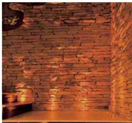
**Luz rasante:** uma luz rasante, direcionada a uma distância de 15 a 30 centímetros da parede, com o objetivo de revelar sua textura. Os raios de luz ficam paralelos ao local que deve ser iluminado, gerando contrastes entre o claro e o escuro, ao mesmo tempo que destacam essa superfície vertical.
