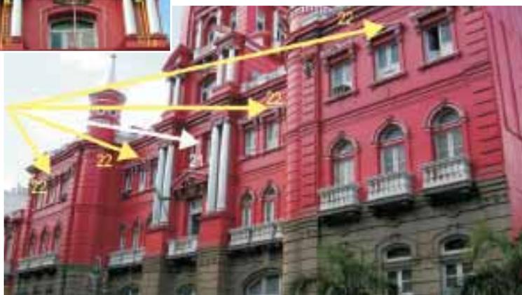
Para equilibrar as sombras resultantes do ângulo de projeção ascendente e cobrir as superfícies em recuo, foi criado um véu de luz complementar, com projetores Focal, de fachos intensivo e semi-intensivo, para lâmpadas de 150W, instalados num poste do outro lado da rua.
