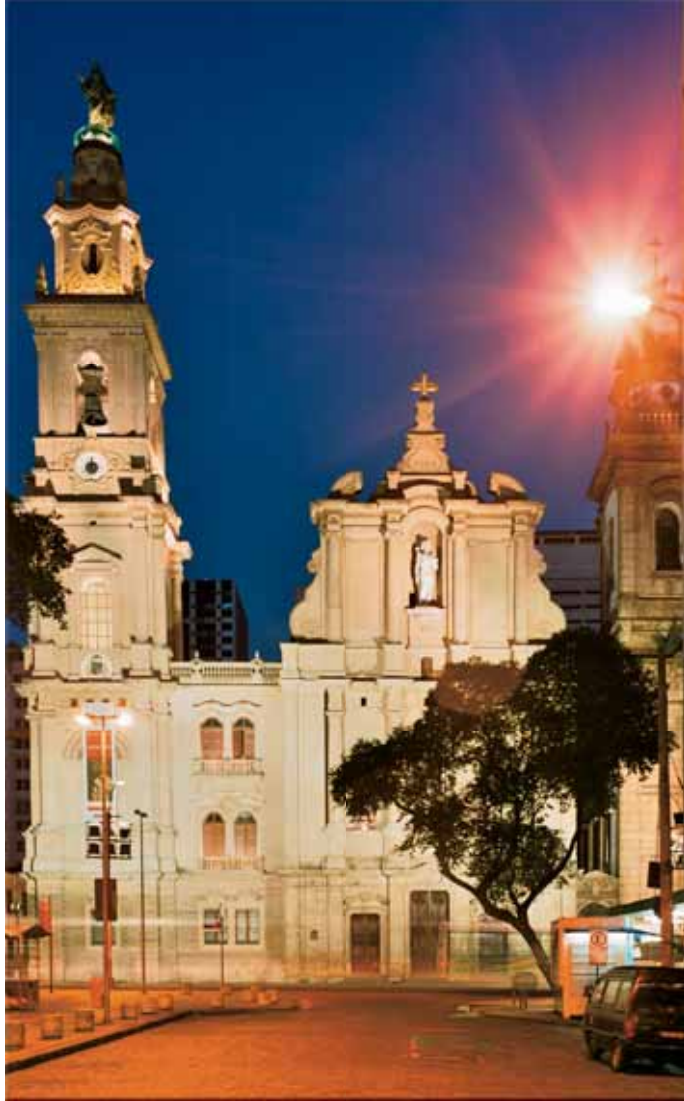
Vista da fachada frontal, com sua iluminação homogênea, feita à distância. Elementos, como a imagem de São Sebastião, o campanário e os vitrais, receberam iluminação de destaque.
