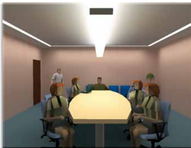
Figura 5 - No caso de mesas compridas, a luminária pendente Indelpla PLIN 3380 2x32W, de luz direta-indireta, atende as necessidades de luz principal de modelagem e de luz de enchimento, além de proporcionar condições para que a câmera trabalhe com boa profundidade de foco, mantendo todos os rostos em foco.
