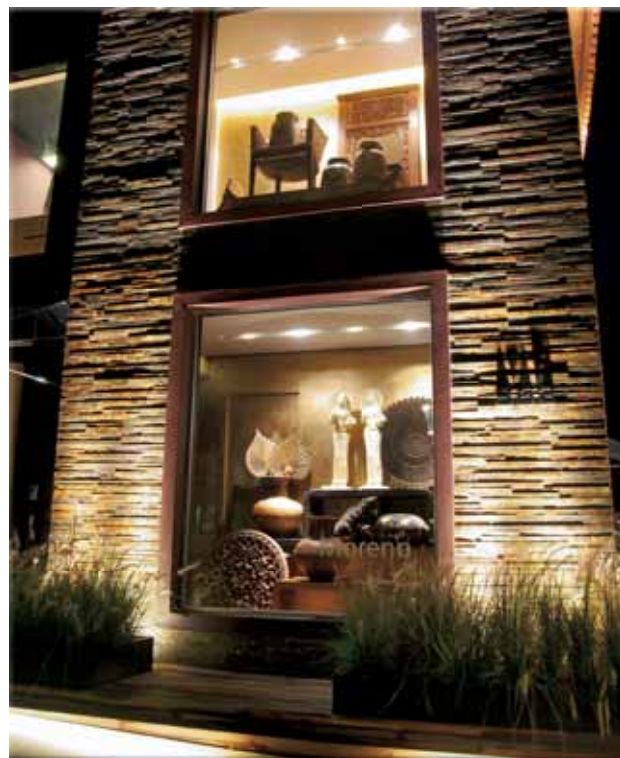
A fachada valorizada por iluminação uplight com lâmpadas CDMR PAR30.
