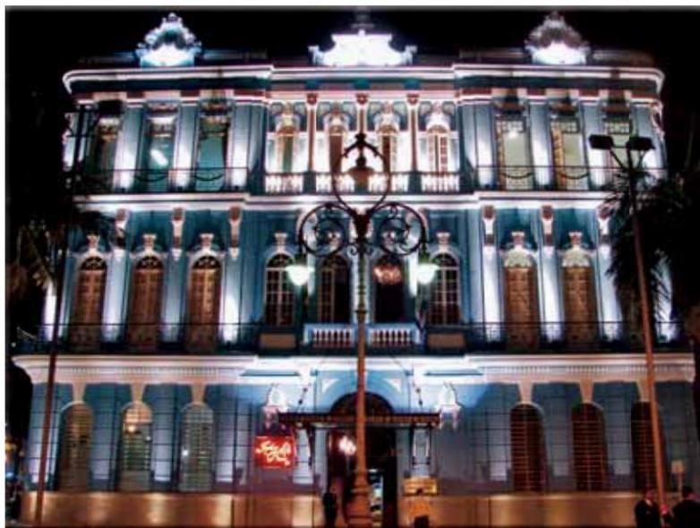
com foco em torno de 30°, para lâmpadas CDM-T de 150W, a 3000K, que iluminaram a parte central da fachada principal. As pilastras laterais receberam luz mais suave, proveniente de luminárias com lâmpadas CDMR 111 de 35W/24°.
