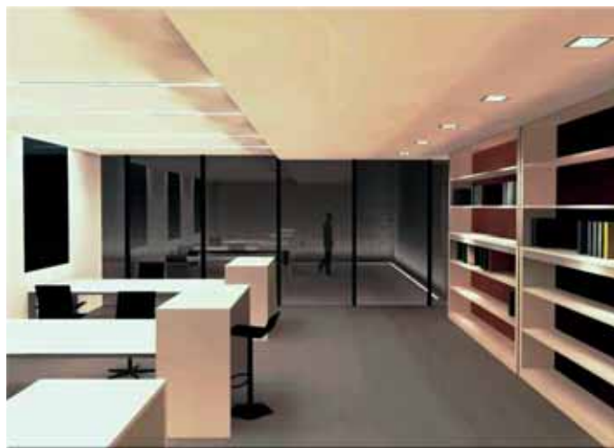
Renderização do mesmo ambiente, utilizando a nova ferramenta disponível no DIALux 4.7 que incorpora transparência e reflexão especular.
