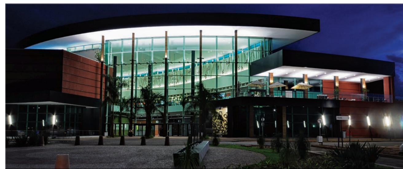
Acima, projetores com lâmpadas de vapor metálico bipino de 150W e fecho assimétrico nos pilares de sustentação jogam luz no teto branco da edificação. À direita, globos de policarbonato fosco brilhante com fluorescentes compactas de 26W a 3000K dispostos de forma escultural para destaque nos banheiros.
