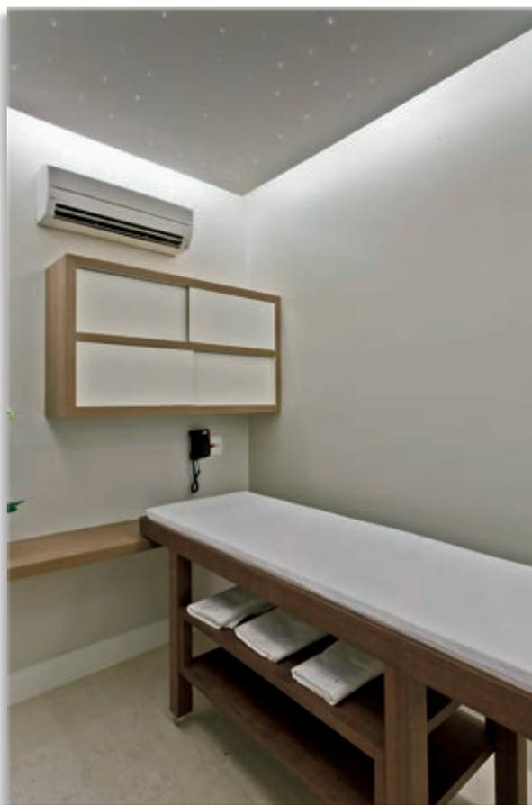
À esquerda, dois embutidos com T5 de 14W a 3000K e uma sanca equipada com a mesma solução iluminam a sala de podologia. À direita, fibra ótica em toda a extensão do teto caracteriza a sala de estética corporal.
