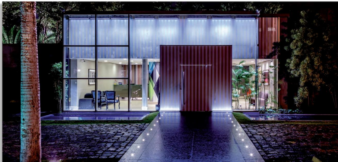
contou. O pórtico da entrada, também em alucobond, recebeu os mesmos projetores, mas em sua base. “Queríamos iluminar este elemento pelo negativo, então ele só aparece porque há luz atrás”, completou. Na passarela de entrada, para criar um efeito monumental, foram utilizados embutidos de solo de LED de 2W.
