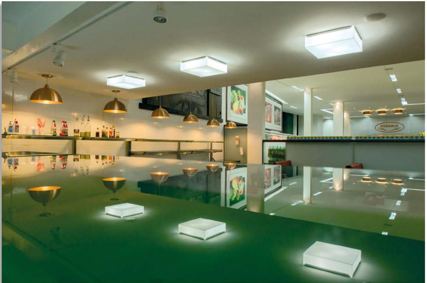
iluminar esta “janela” foi uma sanca invertida, equipada com lâmpadas fluorescentes tubulares de 40W, oferecendo luz difusa, indireta e homogênea para não criar bolhas de luz no vinil (adesivo) tão brilhante. A mesma técnica de iluminação foi usada na parede da adega, onde se encontra a foto de um vinhedo para caracterizar a área dos vinhos.
