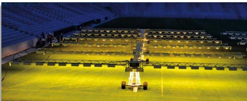
Acima, o campo iluminado com 308 projetores de 2175W a 5600K. Ao lado, sistema de iluminação suplementar equipado com tubulares de 1000W a 5000K, que auxilia na fotossíntese da grama e contribui com o enraizamento.
