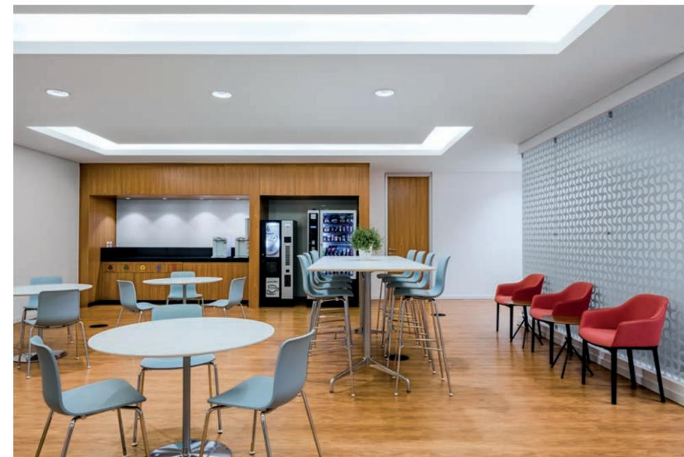
À direita, área de desconpressão conta com luz indireta através de sancas com T5 de 25W a 3000K. Abaixo, embutidos no forro para vapor metálico de 70W a 3000K iluminam o lobby e destacam a parede revestida de madeira.
