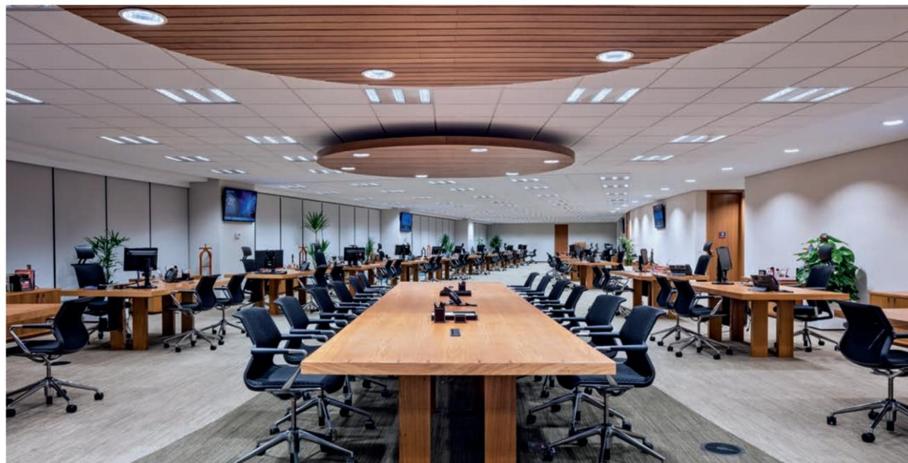
À esquerda, embutidos LED de 20W a 3000K, fixados no forro rebaixado em madeira, proporcionam luz pontual e destacam espaço de conferência na área de trabalho da diretoria.
