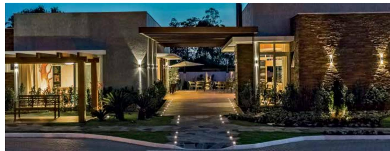
Acima, piscina com luminárias subaquáticas RGB de LED de 12W/15° e IP 68 e áreas internas com arandelas LED de 2W a 3000K nas fachadas e minibalizadores LED de 0,4W a 2700K no deck de acesso ao espaço gourmet.
