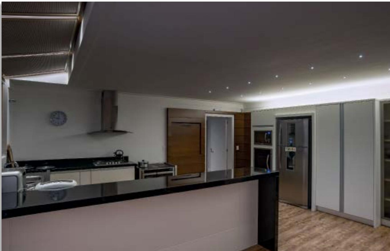
por no teto, fabricadas em acrílico sob medida – para acompanharem as linhas de concretagem – com gelatina em duas tonalidades de cinza, equipadas com T5 de 14W e 28W a 4000K. Próximo à porta que dá acesso à área externa, eletrocalha com spots direcionáveis equipados com AR 111 de 50W/24° e 8° e PAR 30 de 75W proporcionam “movimentos de luz” durante a comemoração.
