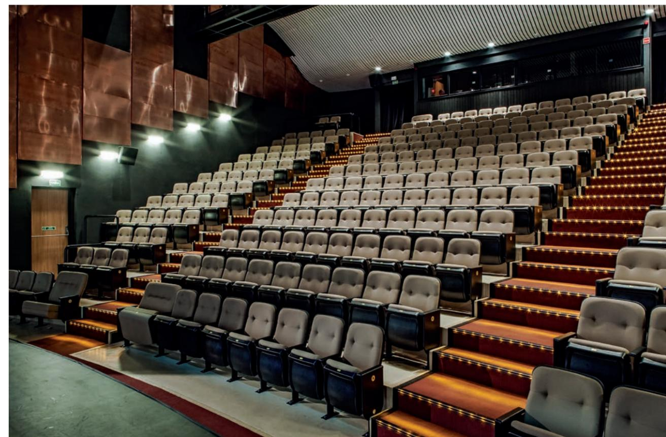
Teatro recebeu balizamento nos degraus da plateia com fitas LED de 3W/m e arandelas retangulares com T5 de 14W a 3000K instaladas a 2,5 metros, nas laterais.
