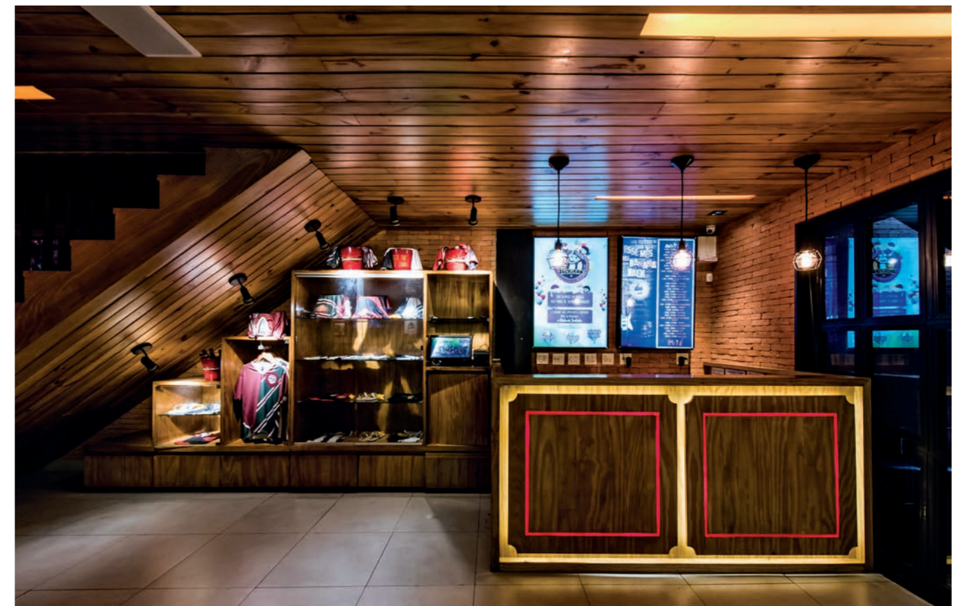
Abaixo, elemento de madeira em alto relevo do balcão do caixa retroiluminado por fitas de LED de 4,8W/m a 3000K. No detalhe, três pendentes com grade aramada e lâmpadas incandescentes de filamento e formato redondo de 40W.
