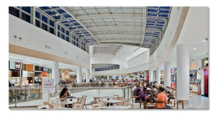
Acima, projetores orientáveis para lâmpadas de vapor metálico de 150W a 3000K fixados na estrutura metálica do terceiro pavimento. Ao lado, praça de alimentação recebeu linhas difusas de iluminação indireta no forro de madeira com lâmpadas de vapor metálico de 150W a 3000K.
