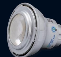
Indicada para substituição direta de halógenas de 35W, esta lâmpada LED da Viribright, marca da Matrix Lighting, consome apenas 4,5W, ou seja, uma economia de energia de 85%. Com base GU 10 e fluxo luminoso de 200 lumens pode ser encontrada na temperatura de cor de 2800K e na tensão 110-120V.
