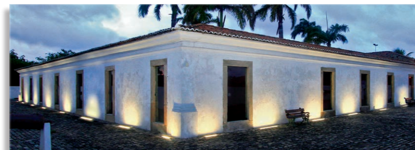
Na foto maior, embutidos no solo com refletor simétrico em alumínio abrihantado e lâmpada de vapor metálico bipino de 150W, a 4200K, destacam as palmeiras da praça das armas. Na foto menor, fachadas do terraplano iluminadas por luminárias lineares embutidas no solo com T5 de 28W e 14W, a 4000K.
