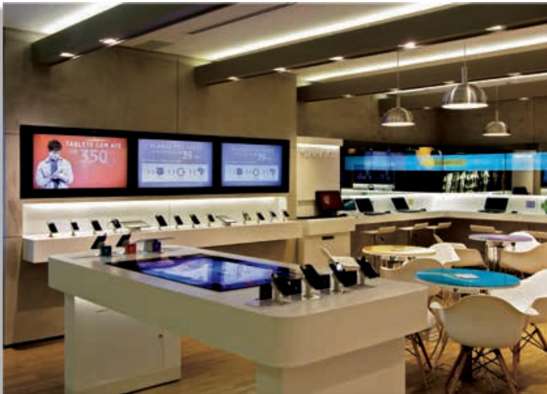
Nas vigas próximas ao teto, optou-se por embutidos com diólicas LED de 10W, para downlight, além de fitas de LED de 10W/m, em sua parte superior, para luz indireta.
